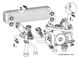
Fig. 134 DHW heat exchanger
