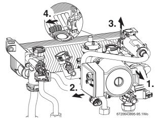
Fig. 133 DHW pressure relief valve
