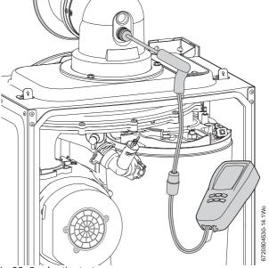
Fig. 83 Combustion test
