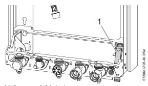
Fig. 64 Pressure relief drain pipe
