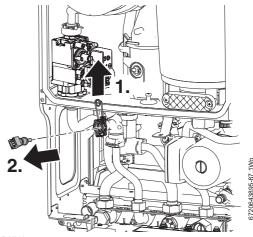
Fig. 125 DHW temperature sensor
